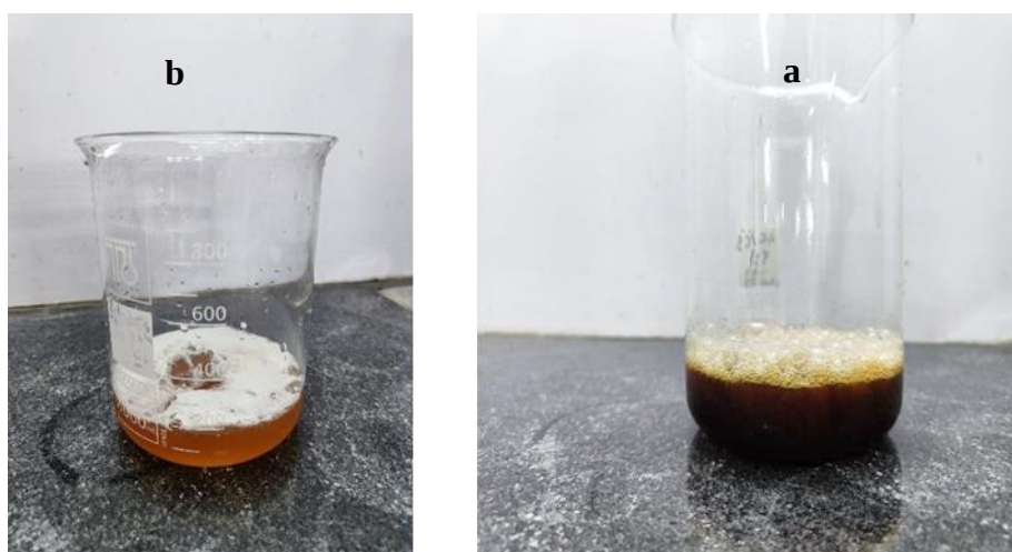
شکل ۲- فرآیند فنتون بلافاصله بعد از اضافه کردن ( \text{H}_2\text{O}_2 و \text{Fe}^{2+} ) با \text{pH}=2 (a) و فرآیند فنتون بعد از ۱۰ دقیقه واکنش (b)
