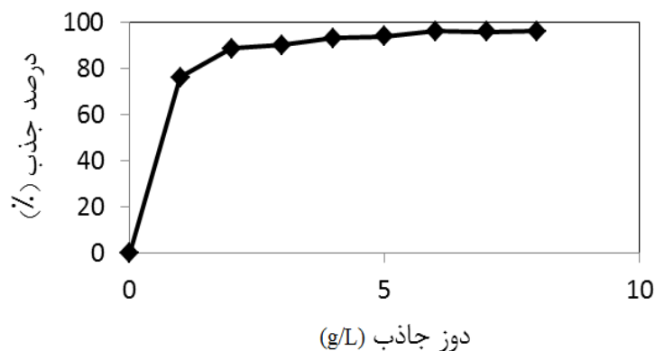
شکل ۵. اثر دوز جاذب بر روی درصد جذب کادمیوم
