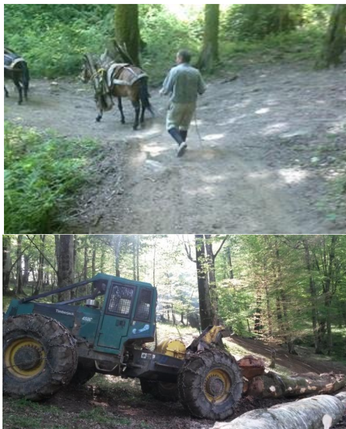
شکل ۲- شیوه انتقال سنتی با قاطر (تصویر بالا) و شیوه چوبکشی نیمه مکانیزه با اسکیدر (تصویر پایین) در منطقه پژوهش
