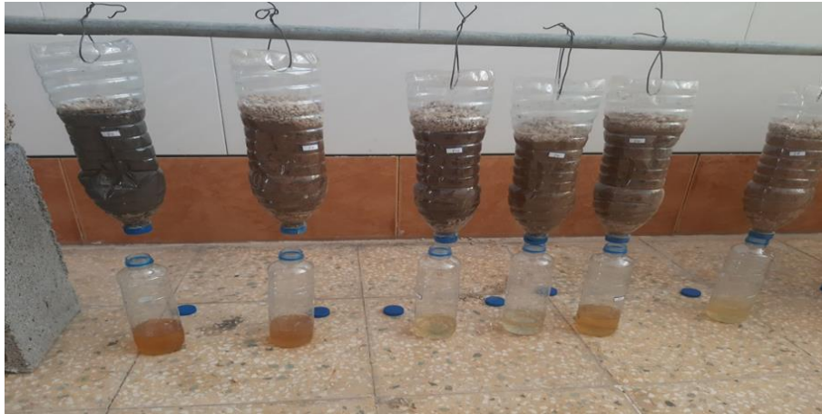
شکل ۴- انجام فیلتراسیون و نمونہ برداری از پساب خروجی از فیلتر.
