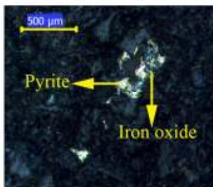
شکل ۴- اکسید شدن بخشی از کانی پیریت و تبدیل آن به ترکیبات اکسید آهن در باطله‌ها گانه آرای معدن سرچشمه
