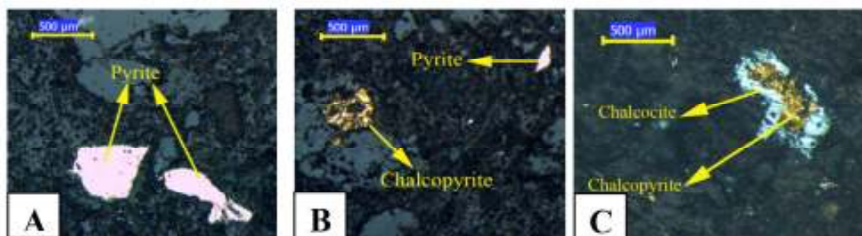
شکل ۳- تصاویر میکروسکوپی از وجود کانی‌های سولفیدی در باطله‌های گانه آرای معدن سرچشمه، A: پیریت، B: پیریت و کالکوپیریت، C: کالکوپیریت و کالکوسیت
