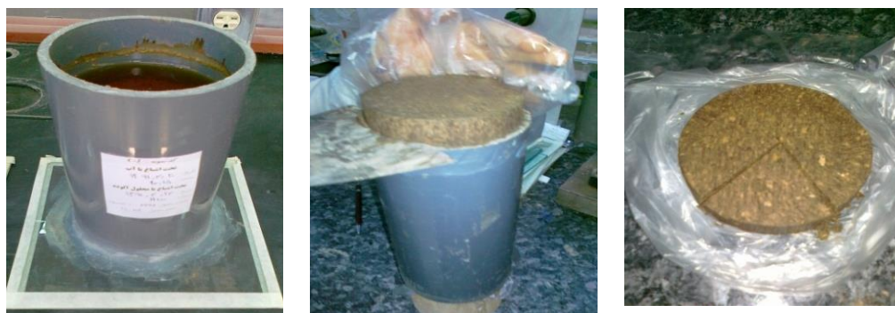
شکل ۱. مراحل برداشت نمونه از ستون‌های انتشار
