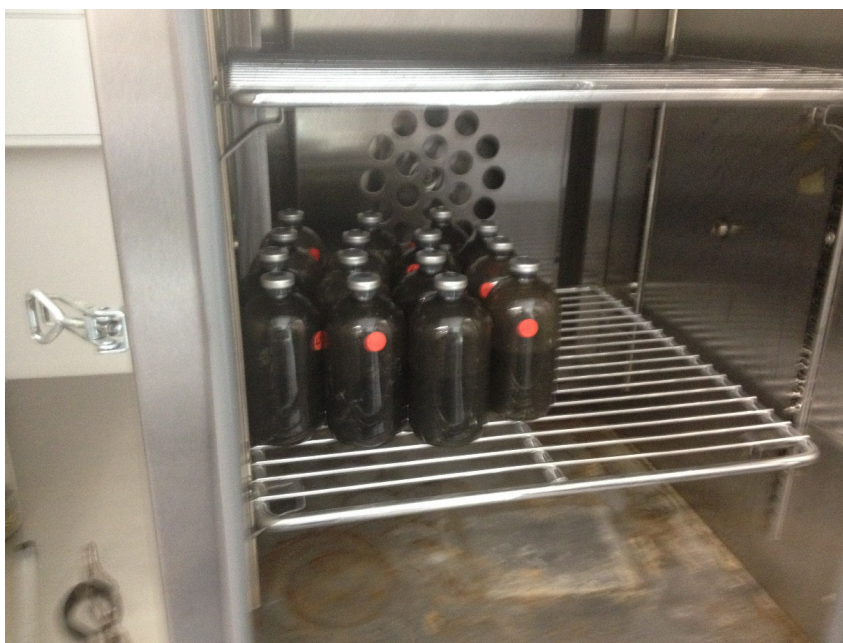
شکل ۱) بطری‌ها بعد از بارگذاری و عایق‌بندی در آون ۳۵ درجه قرار گرفت.
