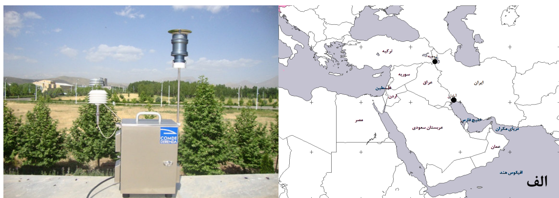
شکل ۱) موقعیت کشور ایران در منطقه خاورمیانه و ایستگاه‌های مورد مطالعه ارومیه و آبادان با علامت دایره سیاه‌رنگ مشخص شده‌اند (الف). نمونه‌ای از دستگاه جمع‌آوری‌کننده گرد و غبار حجم پایین Micro PNS به همراه نمونه‌گیر آن (ب)
